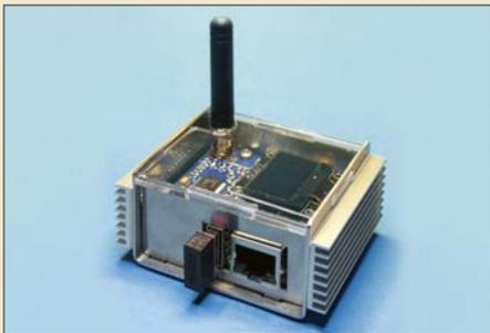
Digitale Sprachanwendungen wie DMR erfordern eine Funkverbindung zu einem Digipeater. Wo dies nicht möglich ist, schließt ein Digital-Voice-Hotspot wie der DVMEGA Euronode die Lücke. Dieser Beitrag stellt das Gerät vor und beschreibt seine Konfiguration für das Brandmeister-Netz unter WPSD.
