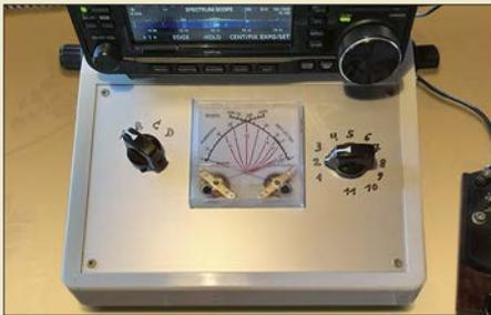
Antennenkoppler sind fester Bestandteil von KW-Funkstationen und gleichzeitig ein interessantes Selbstbauprojekt, wie dieser Bastelvorschlag zeigt. Wenn es, so wie hier, nur um relativ geringe Sendeleistungen geht, braucht man auch keine teuren Spezialteile und der Materialaufwand bleibt insgesamt recht überschaubar. Foto: DK5IQ 630
