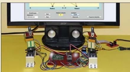
Die Radartechnik ist ein interessantes Gebiet für Hobbyelektroniker. Hier werden drei Ortungsverfahren erläutert, von denen eines in einem einfachen Experiment zur Anwendung kommt. Basis sind zwei preiswerte, den Doppler-Effekt nutzende Radarmodule, mit denen die Position von sich bewegenden oder ortsfesten Objekten feststellbar ist.
