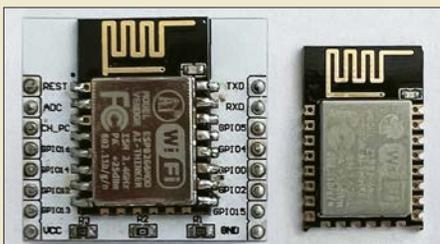
Der Mikrocontroller ESP8266EX und sein Nachfolger ESP32 kommen in vielen Elektronikprojekten vor. Für die Schaltungsintegration werden sie auf Adapterplatinen oder als fertige Entwicklungsumgebung angeboten. Dieser Beitrag beschreibt Unterschiede sowie die Möglichkeiten der Programmierung am Beispiel des ESP-12E.
