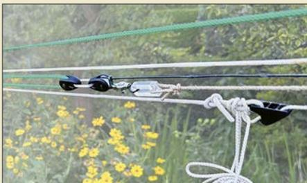
Jedes Antennensystem lässt sich mit einem Antennenkoppler anpassen. Alternativ kann man die Länge des Strahlers so ändern, dass dieses Ziel mit geringerem Leistungsverlust erreicht wird. Hier wird ein Verfahren zur Fernabstimmung von Drahtantennen mittels Leinen und Rollen gezeigt und untersucht, inwieweit sich dieses auch für den Mehrbandbetrieb eignet. Foto: DL8MF 634
