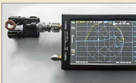
Die elektrischen Werte von Spulen, Kondensatoren und Widerständen lassen sich auch mithilfe eines vektoriellen Netzwerkanalysators bestimmen, wie in diesem Beitrag gezeigt. Darüber hinaus liefert eine solche Messung auch interessante Erkenntnisse zum Verhalten der Bauelemente bei hohen Frequenzen.
