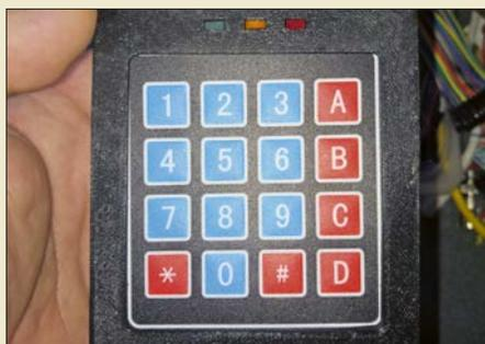
Elektronische Türschlösser, die die Eingabe einer bestimmten Ziffernfolge voraussetzen, lassen sich besonders dort sinnvoll einsetzen, wo keine Schlüssler ausgegeben werden sollen und trotzdem eine Zugangskontrolle erforderlich ist. Die hier gezeigte Variante lässt sich sogar über ein Netzwerk konfigurieren.
