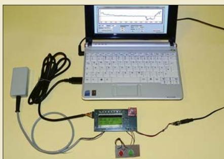
Zwar lassen sich im Internet aktuelle Messwerte zum Erdmagnetfeld finden, doch wenn die aufnehmende Station Hunderte oder gar Tausende Kilometer entfernt ist, sind Aussagen zur Ausbreitungsbedingung vor Ort nur bedingt gültig. Abhilfe kann ein selbst gebautes Fluxgate-Magnetometer schaffen.
