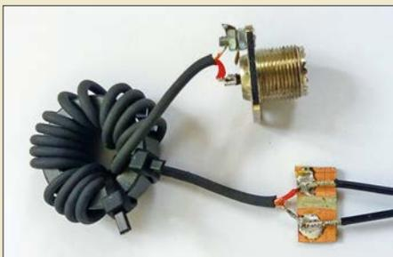
Mantelwellen erwartet man in erster Linie beim Betrieb eines Funksenders. Doch auch bei Empfängern können sie Störungen verursachen. Nachfolgend wird erläutert, wo zur Dämpfung von Mantelwellen geeignete Sperren einzufügen sind und wie Speiseleitungen aufgebaut sein sollten.
