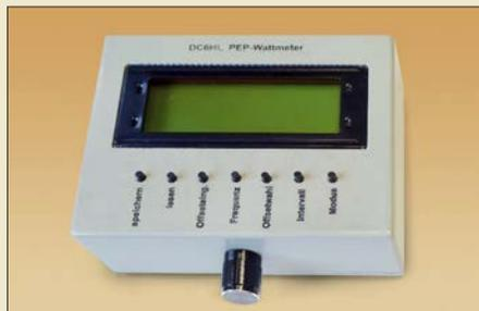
Das hier beschriebene Wattmeter ist für Signalfrequenzen bis 450 MHz konzipiert. Bei seiner Entwicklung wurde besonderer Wert auf eine hohe Messgenauigkeit gelegt. Im Gegensatz zu vielen anderen Ausführungen von Leistungsmessgeräten kann es auch die Hüllkurvenspitzenleistung (PEP) korrekt anzeigen. Foto: DC6HL
