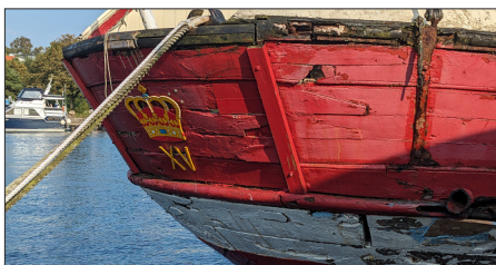
Bild E3: Auch hier sind die dringend benötigte Reparaturen deutlich zu sehen.
