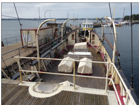
Bild E4: Blick auf den hinteren Teil des Feuerschiffs; die Aufhängevorrichtung für zwei Rettungsboote ist noch vorhanden.
