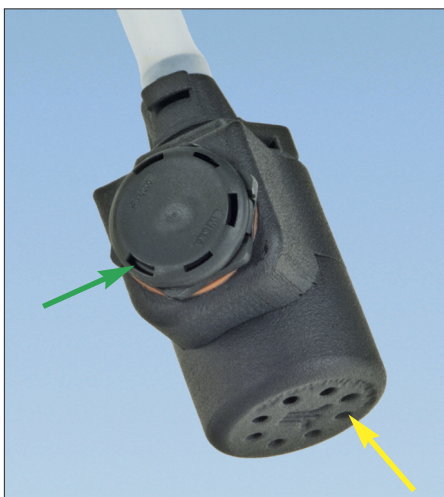
Gehäuseverschraubung für Druckausgleich und Kondensatableitung von [5]; der grüne Pfeil weist auf die Schlitze des Luftein- und -auslasses aus dem Schaltschrankinneren, der gelbe auf die Öffnungen für den Kon- densatauslass. Foto: DL1DBL
