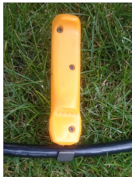
Bild 6: Das Abmanteln sollte mit geeignetem Werkzeug erfolgen. Fotos: Red. FA
